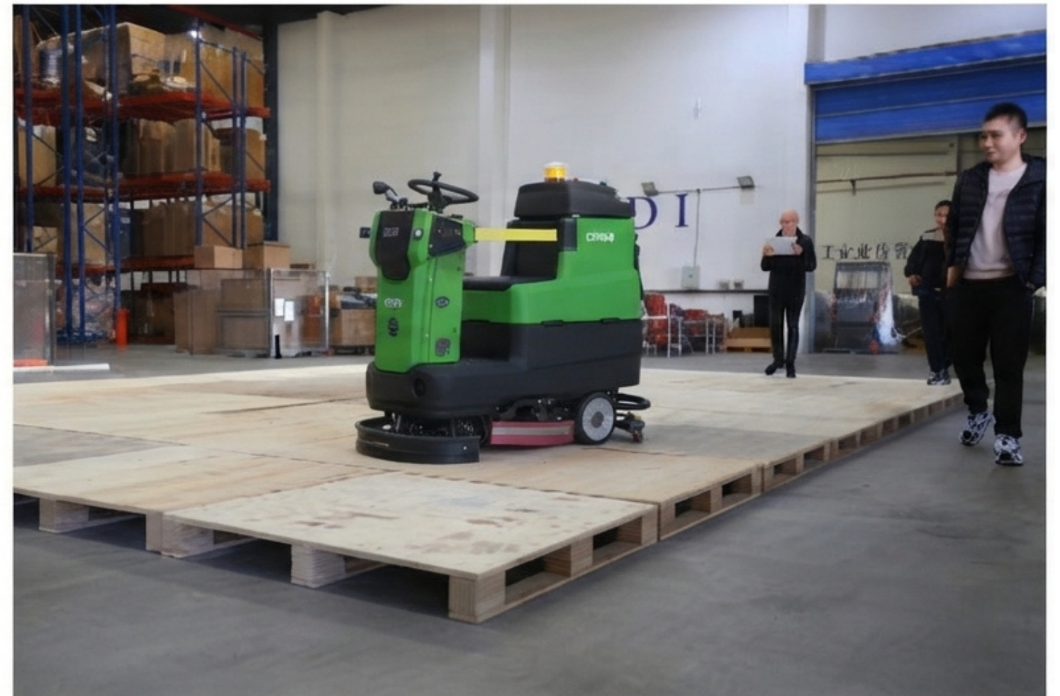
ระบบป้องกันหุนยนต์ AMR ตกจากขอบ (AMR anti-cliff)
